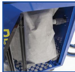
Leicht zugängliche Seitentüren zum einfachen Austausch von Staubfiltern und Schleifstaubsäcken
